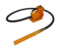
Вибратор электрический глубинный ручной с гибким валом и вибронаконечником ВИ-1-13 предназначен для уплотнения бетонных смесей при укладке их в монолитные конструкции с различной степенью армирования, а так же при изготовлении бетонных и железобетонных изделий для сборного строительства. Вибронаконечник имеет планетарный вибрационный механизм. Диаметр вибронаконечника подбирается с учетом расстояния между стержнями
