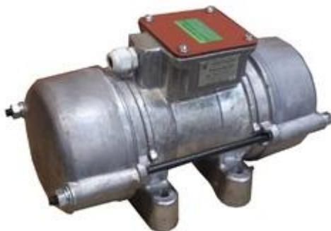
Вибратор электромеханический общего назначения с круговыми колебаниями ВИ-127 Н предназначен для возбуждения вибрации в установках по уплотнению бетонных смесей и грунтов, транспортированию, выгрузке и просеиванию сыпучих материалов, привода вибропитателей, виброплощадок и других технологических работ, в т.ч. для мини кирпичных блочных установок. Модели повышенной надёжности имеет смысл использовать при высокой нагрузке и длительных включениях, а это бывает только на производствах.
